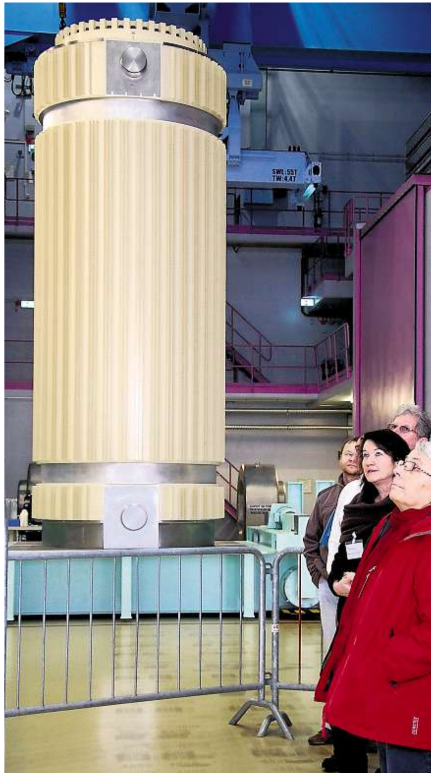
Roboter laden den radioaktiven Atom­müll aus solchen Castor-Behältern in der «heissen Zelle» in die Behälter für das Tiefenlager um. Bild: Céline Trachsel
